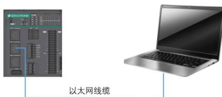
图 2-3 控制器和 PC 通过网线连接
