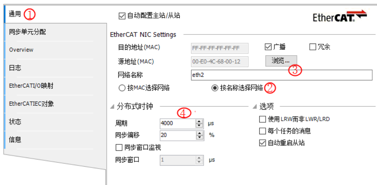
图 4-3 配置 EtherCAT 网口
