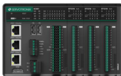
图 2-2 SC302 运动控制器 + ET 系列 IO 模块 正面图
