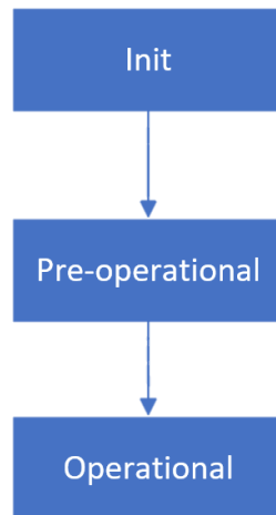
图 7-30 ET 系列 I/O 模块状态机
