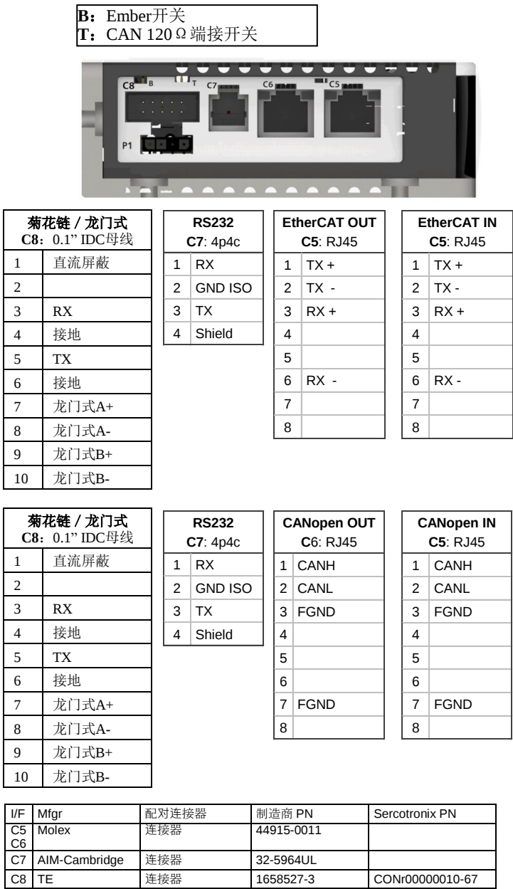
图 4-17. CDHD2（低压）控制板引脚分配 - 上面板
